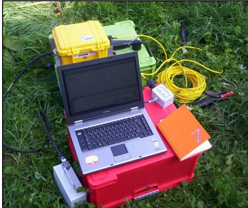
Figura 2: Strumentazione utilizzata per la prova MASW.
